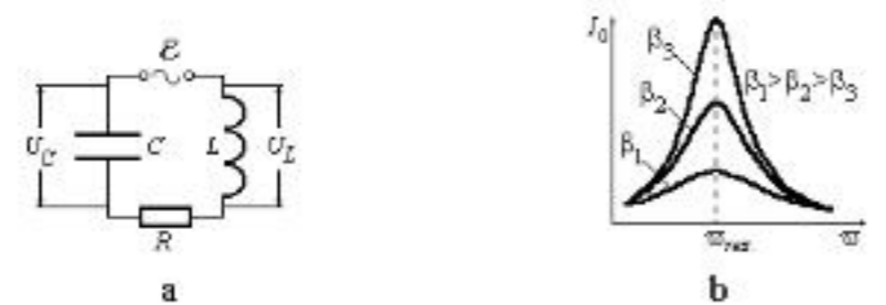
260 pav. Priverstiniai suyravimai kontūre (a) ir rezonansinės kreivės esant įtampos rezonansui (b)
