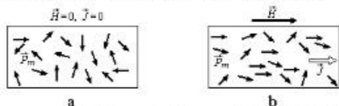
240 pav. Paramagnetikai nesant išorinio magnetinio lauko (a) ir lauke (b)
